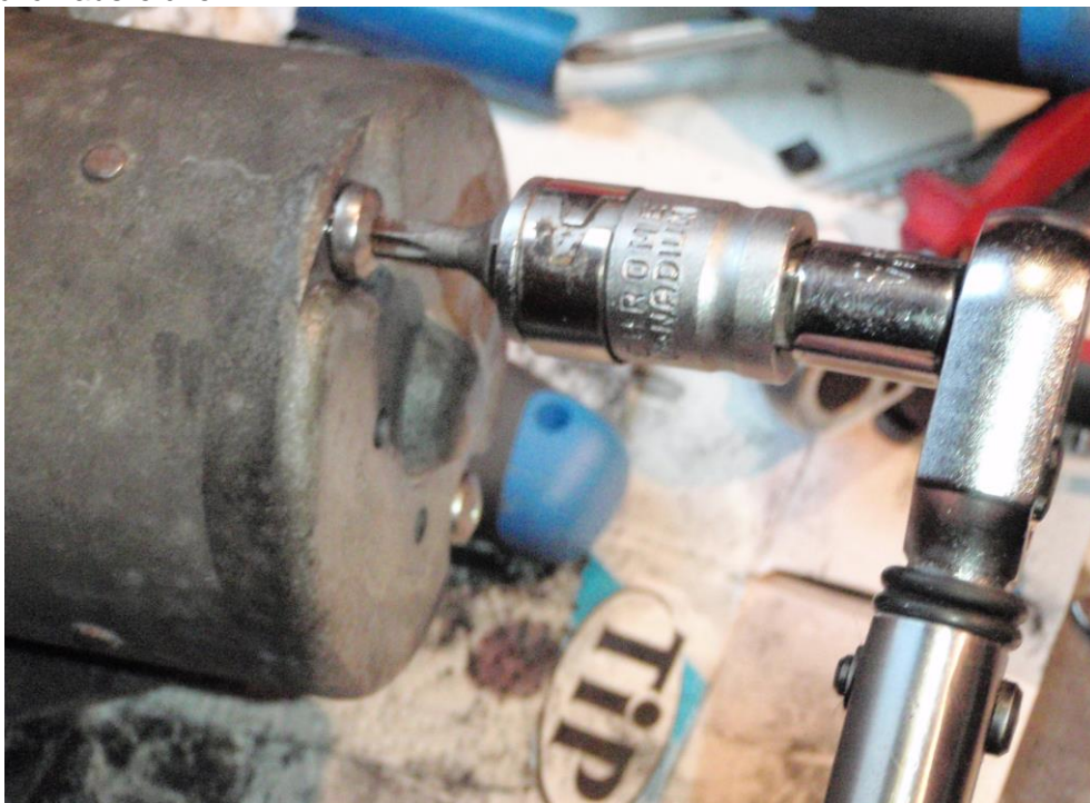
Abbildung 14: Anziehen der Schrauben mit Drehmomentschlüssel
