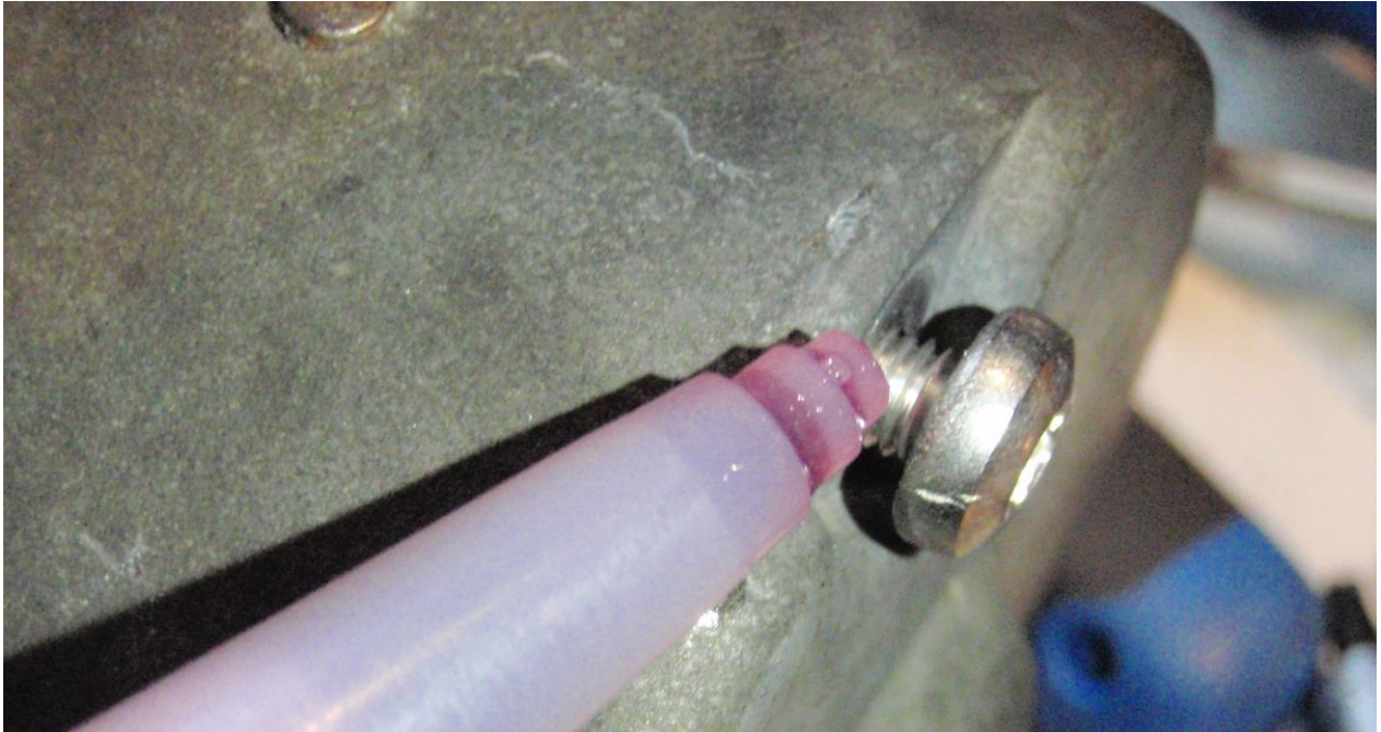
Abbildung 13: Schraubendichtung unter dem Kopf
